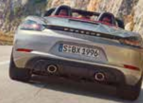
Sportabgasanlage mit 2 auseinander gerückten Endrohren aus Edelstahl in Silber (Hochglanz)
